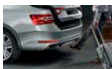
Virtuální pedál – bezdotykové otevírání 5. dveří
